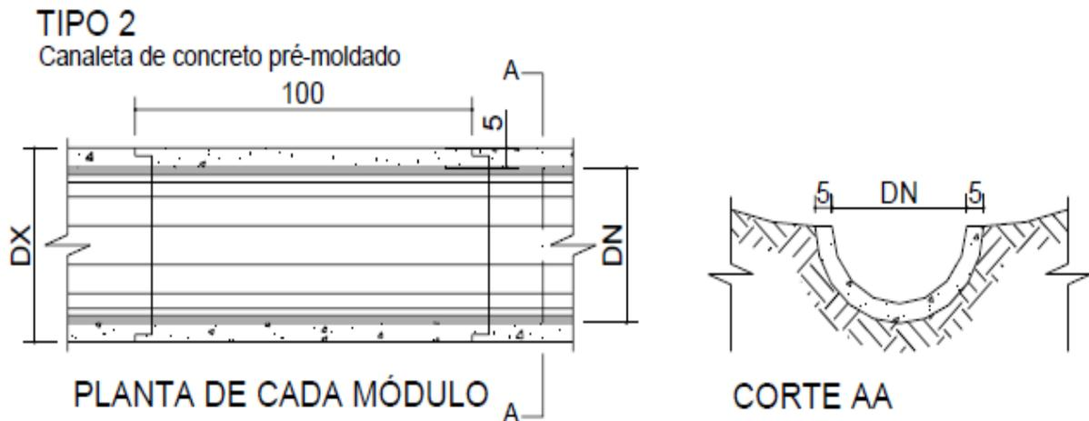
Em todos os tipos de canaletas, o terreno de fundação deverá ser regularizado e apiloado manualmente.
