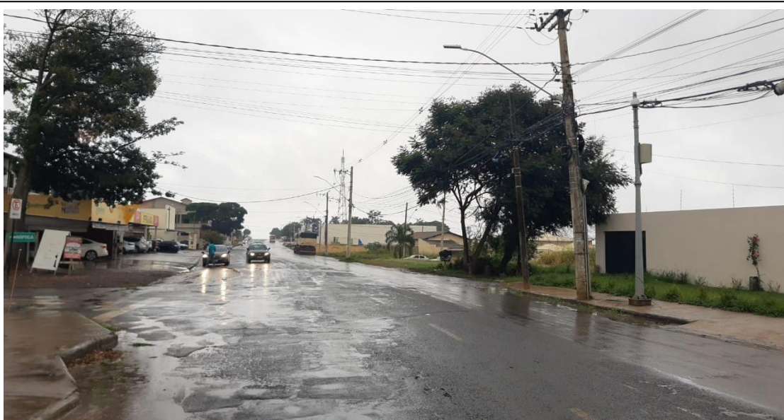
PTZ 48: Rua Honório de Paiva Abreu Poste: 6 metros Suporte prolongador: 4 metros Referência: calçada (próxima ao Supermercado Primavera)
